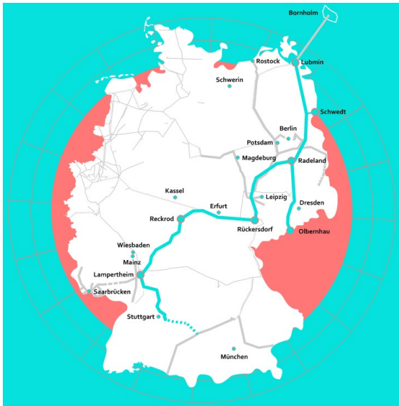
Abbildung 26: Geplanter Trassenverlauf Flow (Quelle: https://www.flow-hydrogen.com/ )
