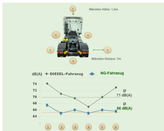
Abb. 7: Lärmemissionen Gas-Otto-Motor im Vergleich zu Diesel-Motor Quelle: IVECO
