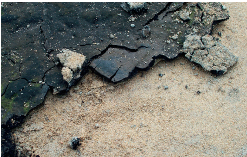
Abb. 2: Aufgebrochene Schicht aus Aktivkohlepulver, anderen abgelagerten Schwebstoffen und Algen auf einem Langsandsandfilter (Schichtmächtigkeit 1-3 cm)
