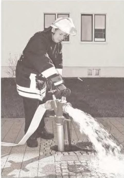
Ein Abgang am Standrohr wird geöffnet.
